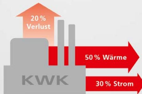
Kraftwerk mit Kraft-Wärme-Kopplung
