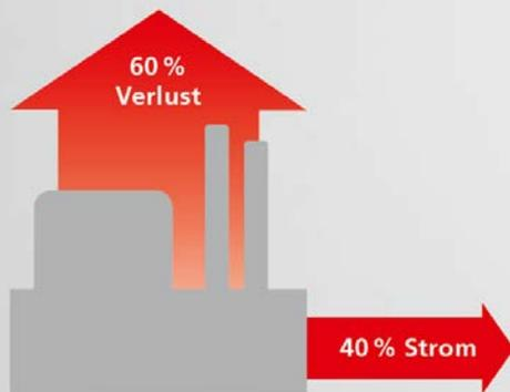
Kraftwerk ohne Kraft-Wärme-Kopplung
