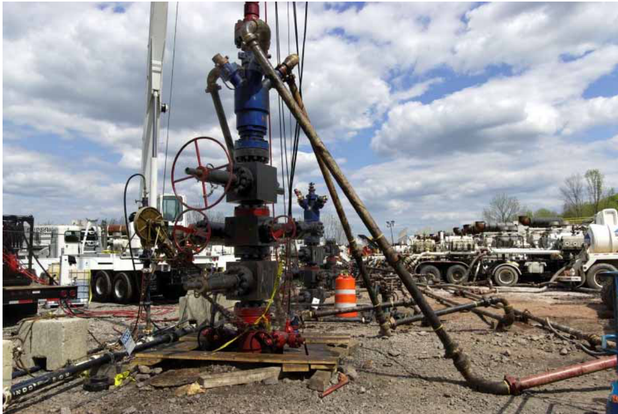
Bild 4: Bohrstelle während des frac-prozesses. (Quelle: SGEIS – Report draft, 30. September 2009 [7])
